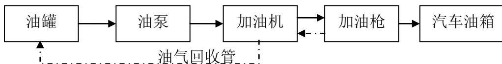
图 2-3 汽油加油工艺流程示意图
