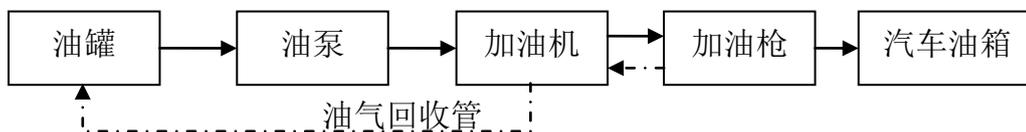
图 2-3 汽油加油工艺流程示意图
